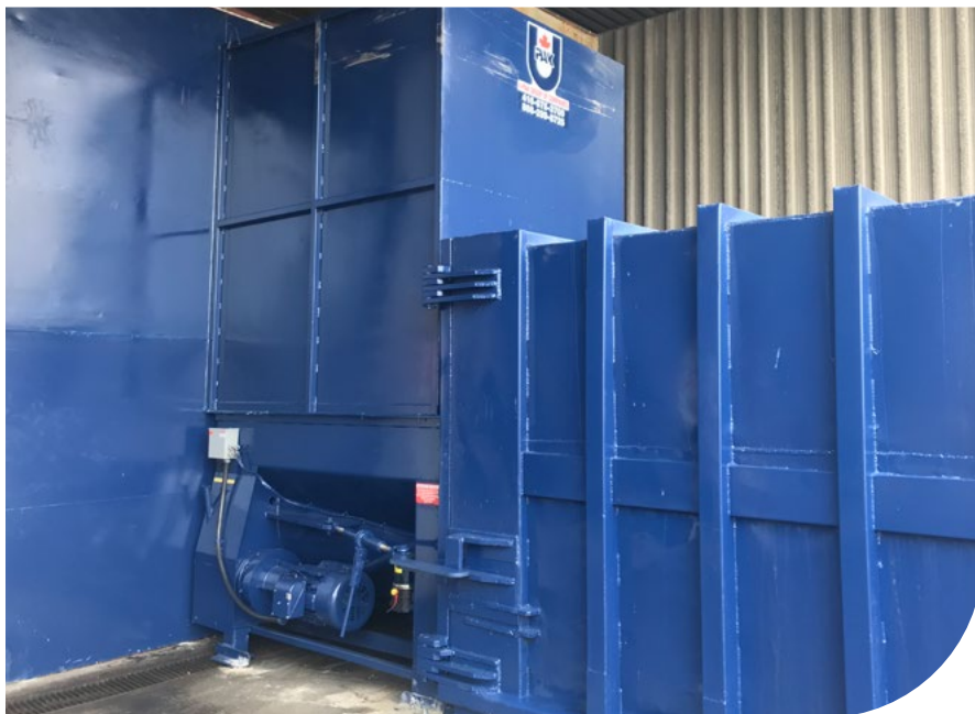
Un compacteur de carton à notre établissement de traitement du courrier de Hamilton permet de libérer de l'espace opérationnel et de détourner le carton aux fins de recyclage.
